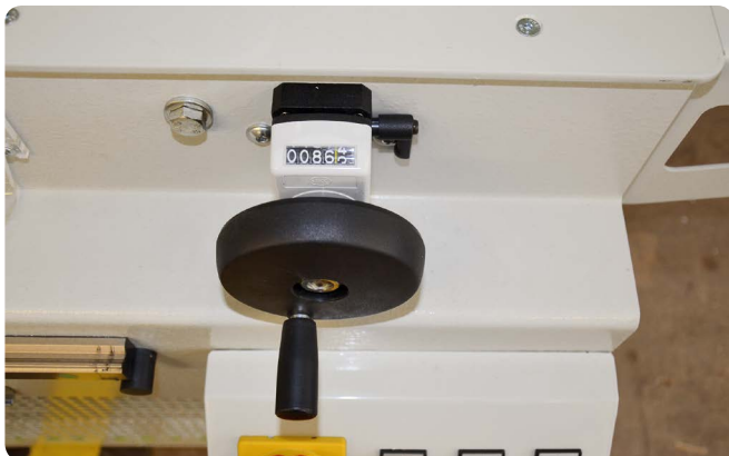
Verstellbare Bohr- und Fräsposition über Handrad
