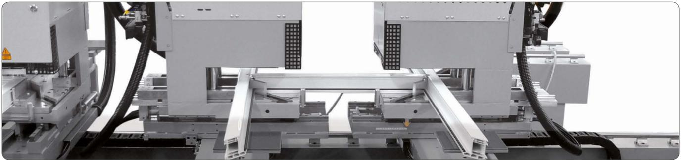
Die beiden rechten Schweißköpfe sind um 90° drehbar um H-Schweißungen durchzuführen (Bild oben).
